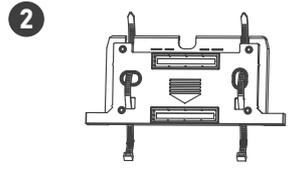
2 Usa el cable para pasarlo A través del soporte. Asegúrate de que el lado dentado quede hacia adentro.
