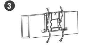
3 Fija el soporte al poste y alinea la parte superior del soporte con la parte superior del poste.
