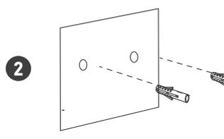
2 Perforar e insertar los Tornillos de expansión En la pared
