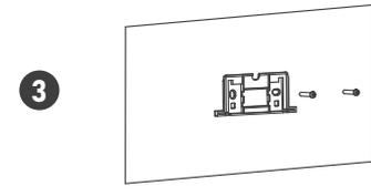
3 Fijar el soporte a la pared Con tornillos
