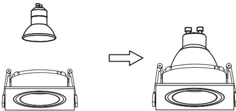
**Coloque a presión la lámpara en el aro.**
